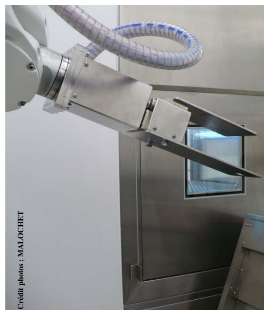
Modèle présenté en acier inoxydable 316 L avec portillon interfacé au bras robotisé
